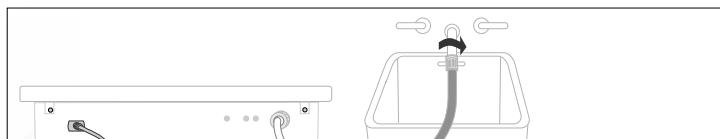
2. Подсоедините другой конец шланга для подачи холодной воды к крану холодной воды в раковине и затяните рукой. При необходимости, вы можете изменить положение конца шланга для подачи воды, подсоединенного к машине, ослабив фитинг, повернув шланг и вновь затянув фитинг.
