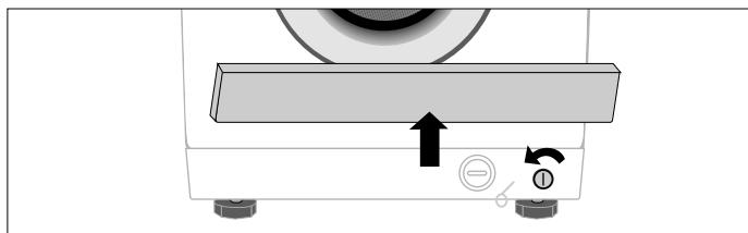
3. Отверните крышку аварийного слива, вращая ее в левую сторону. Возьмитесь за колпачок на конце трубы для аварийного слива и медленно вытяните трубку примерно на 20 см.
