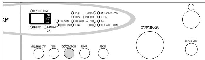
7. Последовательно нажмайте кнопку ручного выбора функций машины, для выбора нужного режима стирки:
