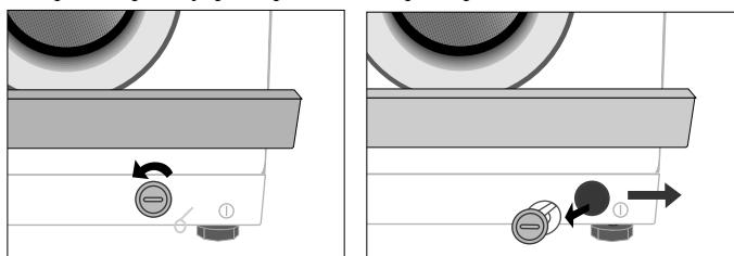
4. Вымойте фильтр и удалите из него грязь или скопившиеся ворсинки. Убедитесь в том, что не заблокирована грязью крыльчатка сливного насоса, расположенная сзади фильтра. Установите на место фильтр и его крышку.
